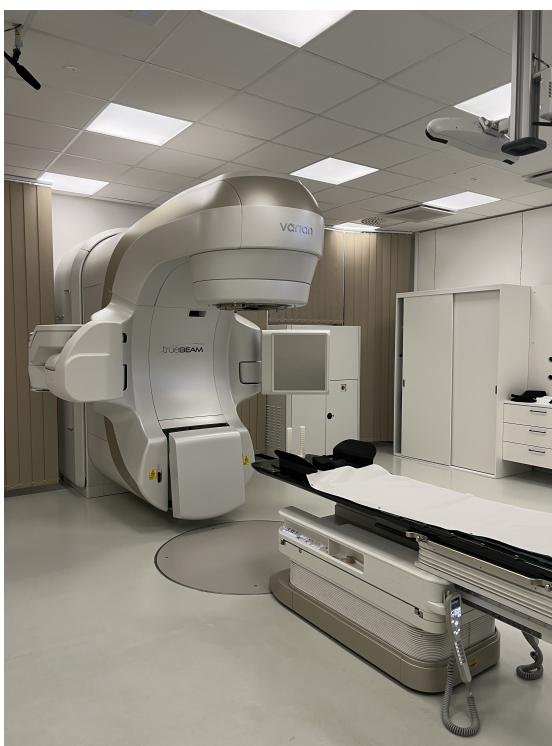
Kuva 1. Keski-Suomen Sairaala Novan sädehoidossa käytettävä Varian True-Beam -lineaarikiihdytin.
