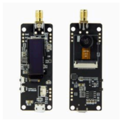
Kuva 3.5: LILYGO TTGO T-Journal ESP32-kameramoduulin kehityskortti [21]
