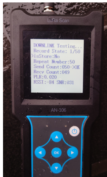
Kuva 4.9: Signaalitesteri testaamassa Downlink-sanoman onnistumista
