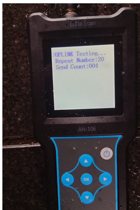
Kuva 4.10: Signaalitesteri testaamassa Uplink-sanoman onnistumista
