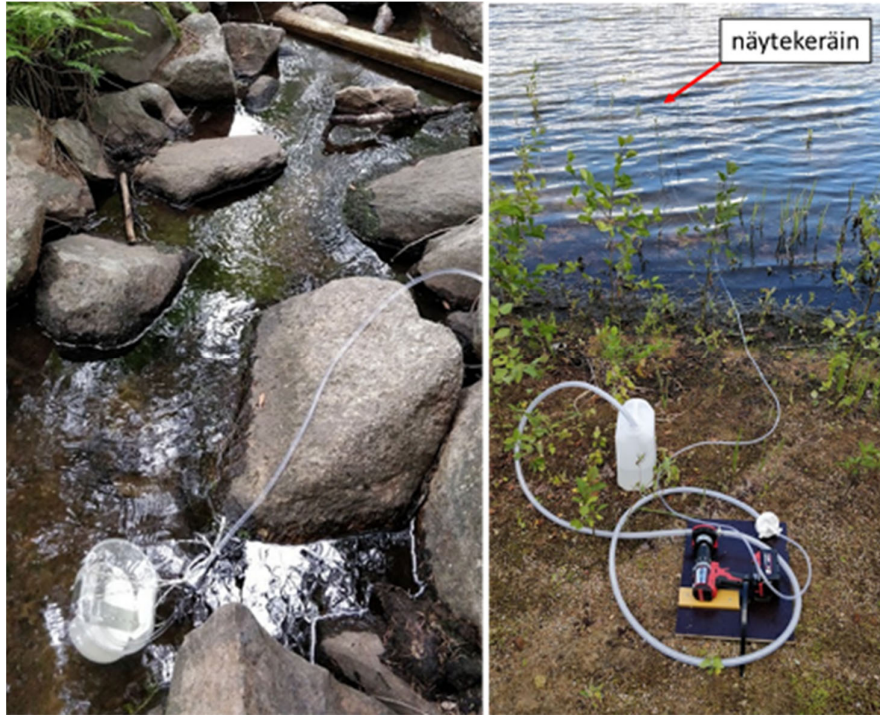
KUVA 8 Vasemmalla näytekeräin asetettuna puroon ja oikealla keräin heitettynä järveen. Kuvat: Timo Ruukonen
