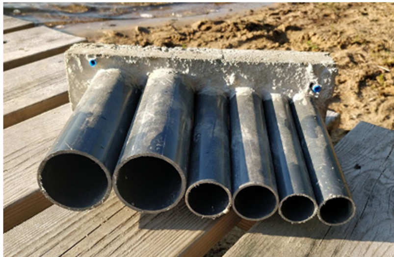
KUVA 3 Tutkimuksessa käytetty kolopyydysmalli. Putkien sisähalkaisijat olivat 56 mm, 36 mm ja 28 mm. Kuva: Timo Ruukonen.
