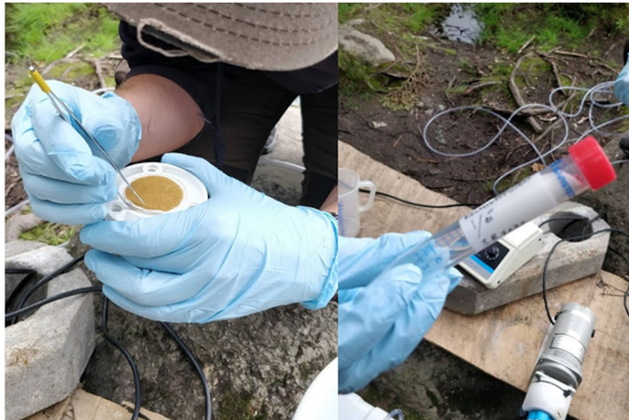
KUVA 7 Vasemmalla suodatinpidike ja näyteveden ruskeaksi värjäämä suodatin. Oikealla suodatin taiteltuna steriiliin näyteputkeen. Kuva: Timo Ruukonen.
