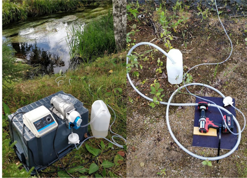
KUVA 5 Vasemmalla peristalttipumpun käyttöön perustuva näytteenottolaitteisto, oikealla vastaava akkuporakonepumpulla varustettu laitteisto. Kuvat: Timo Ruokonen.
