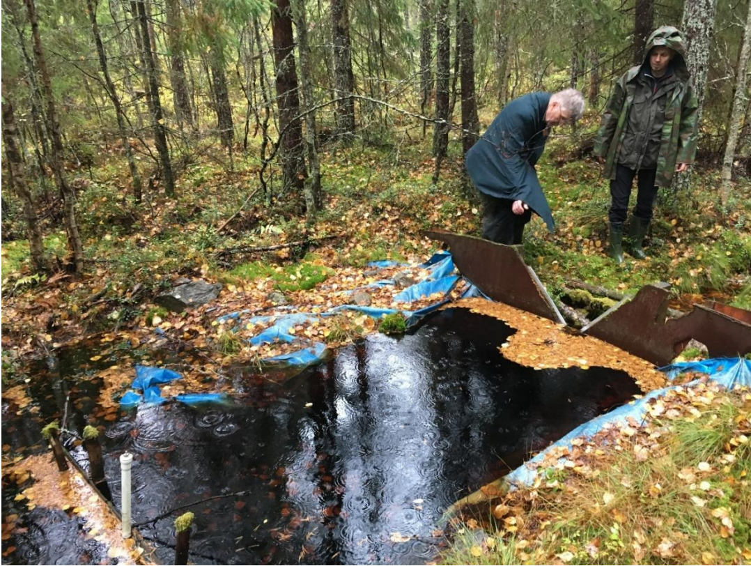
Kuva 5.7. Ennallistetun korven hydrologinen seurantapiste Pirkanmaalla. Kuvassa näkyvä patorakenne mahdollistaa standardoidun vesinäytteenoton, jonka avulla voidaan seurata ja vertailla usealta ennallistamiskohteelta ja niiden kautta valuvan veden ravinnepitoisuuksia. Kuvan vasemmassa alareunassa näkyy vedenpinnan tason muutoksia mittaavan dataloggerin sijoitusputki. (Kuva: Santtu Kareksela).
