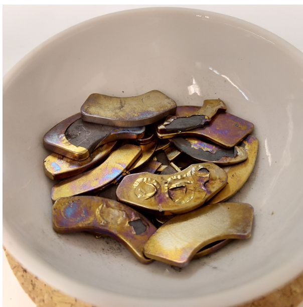
Kuva 14: Magneetit demagnetisoinnin jälkeen. Kuvassa on nähtävissä magneettien nikkelisuojakuoren osittainen irtoaminen magneetin pinnasta.
