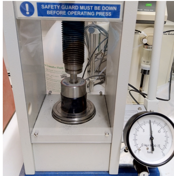
Kuva 18: Käsikäyttöinen Specac-hydraulipuristin. Kuvassa nähtävissä myös pellettien valmistuksessa käytetty metallisylinteri ja mäntä.
