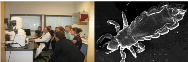
Kuvio 25 Elektronimikroskoopi ja laitteella otettu kuva päättäistä.
