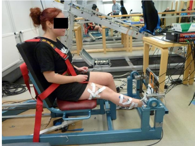
KUVA 9. Nilkan ojennuksen isometrisen maksimivoiman mittaaminen voimadynamometrilla.
