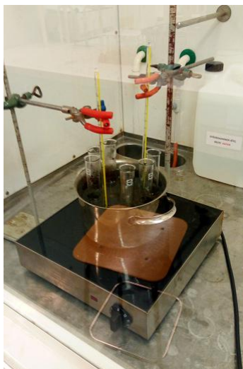
Kuva 21. Allaniittirikasteen liuotusta 50 °C:n vesihautteessa.
