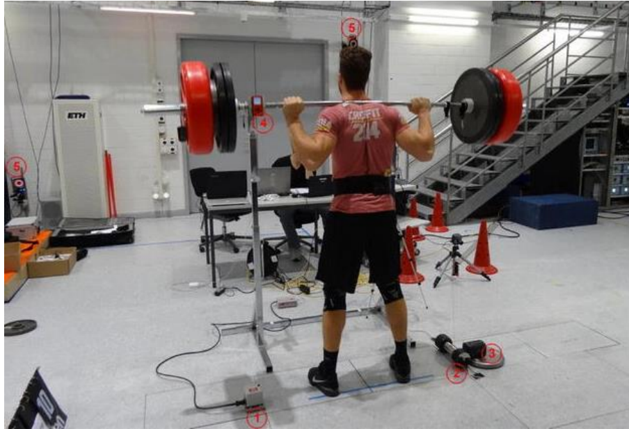
KUVIO 43. Levytangon oikeassa reunassa on GymAware-laite (numero 2) ja tangon vasemmalla puolella tangossa kiinni on Myotest-laite (numero 4) (Lorenzetti ym. 2017).
