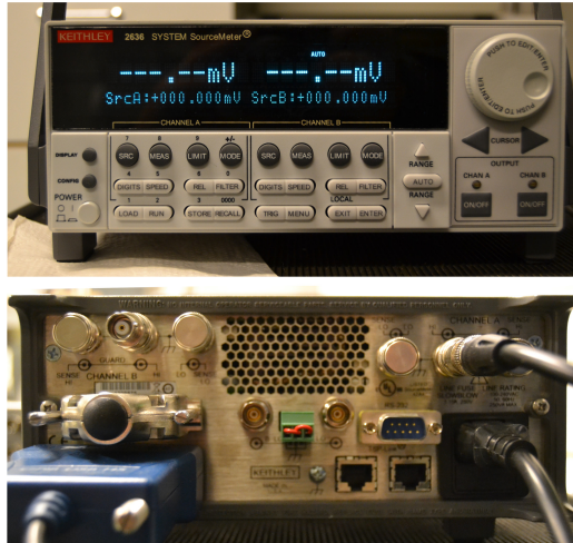
Kuva 27: Keithley 2636 SMU -mittalaitteisto. Ylemmässä kuvassa etupaneeli, alakuvassa takapaneeli ja siitä lähtevät liitännät.
