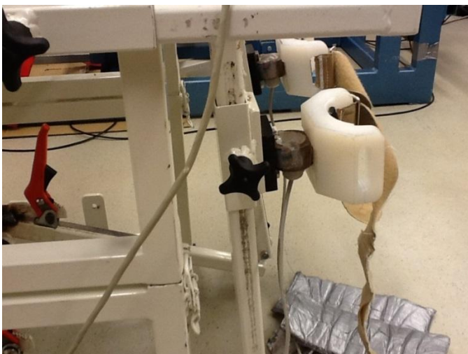
KUVA 16. Reisipenkin siteet, joilla sääret kiinnitettiin tarranauhoilla penkin valkoisiin tukikappaleisiin. Harmaat tyynyt toimivat pehmusteena säären ja tarranauhan välissä.
