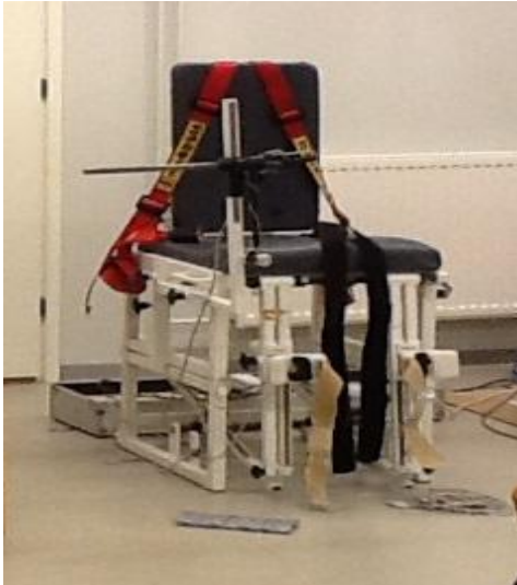
KUVA 15. Reisipenkki kiinnitysvöineen. Kuvassa näkyy myös patellarefleksin mittaamiseen käytetty heilurivasara vasemmalla.
