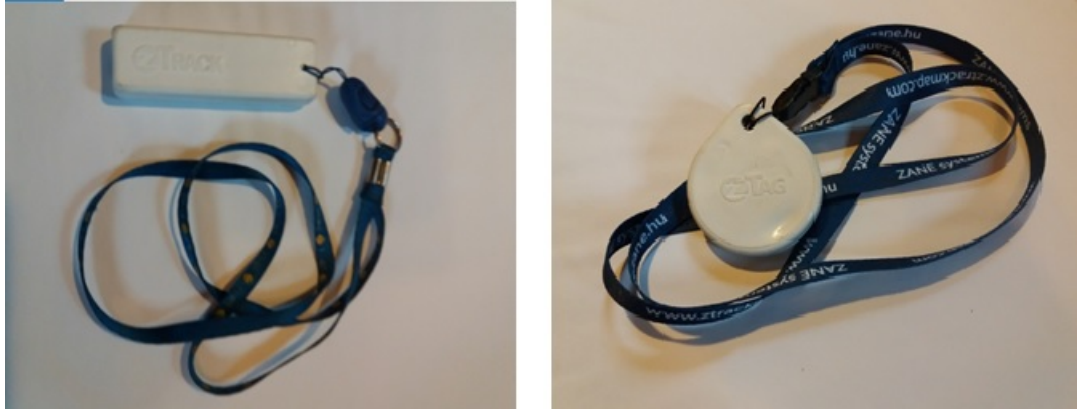
Kuva 4.2: Vasen kuva on laitteesta zTrack Mini LoRa GPS Tracker EU868 (laite 1) ja oikea kuva on laitteesta zTag (laite 2)
