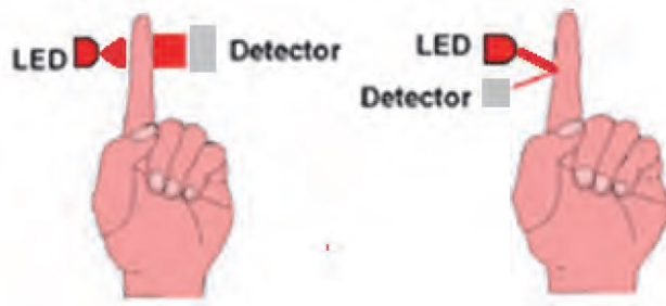
Kuva 3.3: Pulssioksimetrian toimintatavat. Vasen kuva on lähetyspulssioksimetriasta ja oikea heijastuspulssioksimetriasta. [1]
