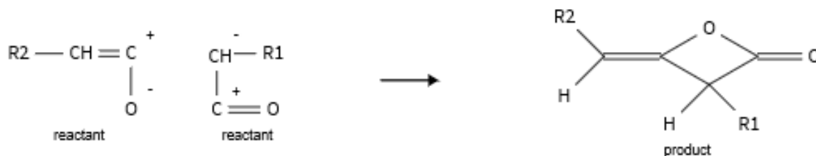
Kuva 12 Reaktio toinen vaihe; keteenidimeerirakenteen muodostuminen.
