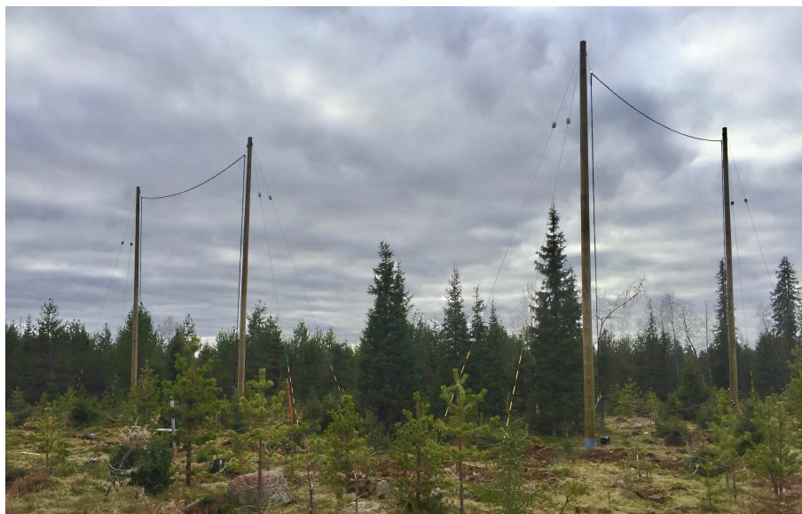
Kuva 3.2: Kannuslehdon VLF-vastaanottimen silmukka-antennit. (Kuva: J. Manninen)
