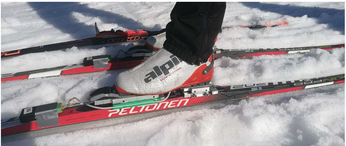
KUVA 16. Jyväskylän yliopiston kehittämät sidevoima-anturit.
