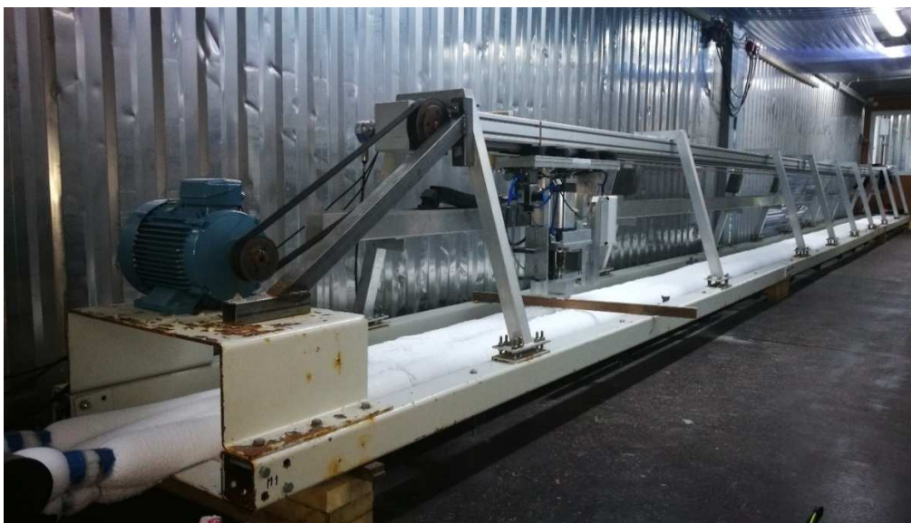
KUVA 10. Jyväskylän yliopiston liikuntabiologian laitoksen Vuokatin yksikön lineaaritribometri.
