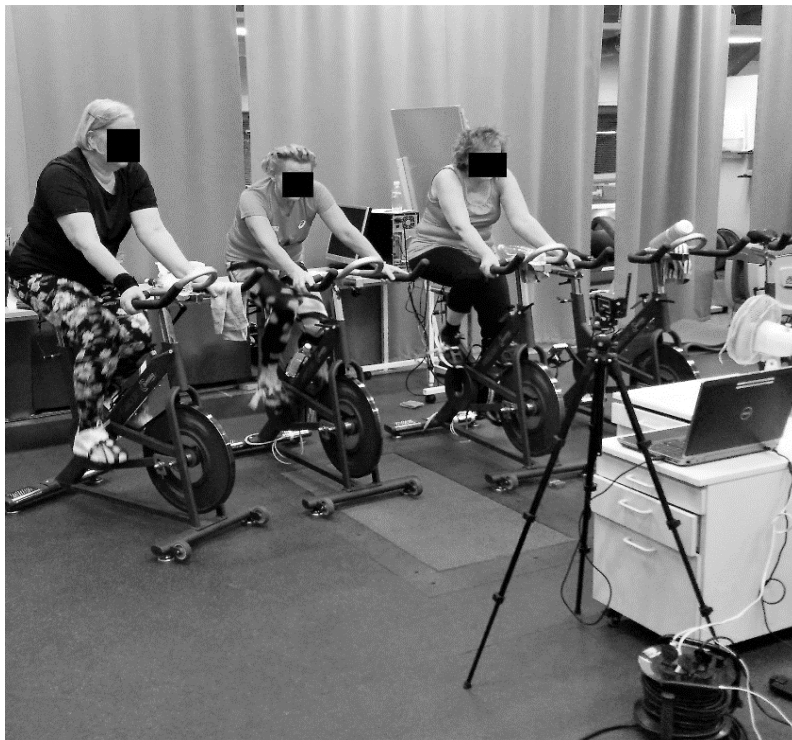
KUVA 9. Tutkittavia polkemassa kestävyysharjoitusta. Jokaisella on oma sykevyö, joka lähettää sykedataa Firstbeatin Team Receiver -vastaanottimeen. Tutkittavat seuraavat sykereaktiotaan reaaliaikaisesti edessä olevalta tietokoneen näytöltä.
