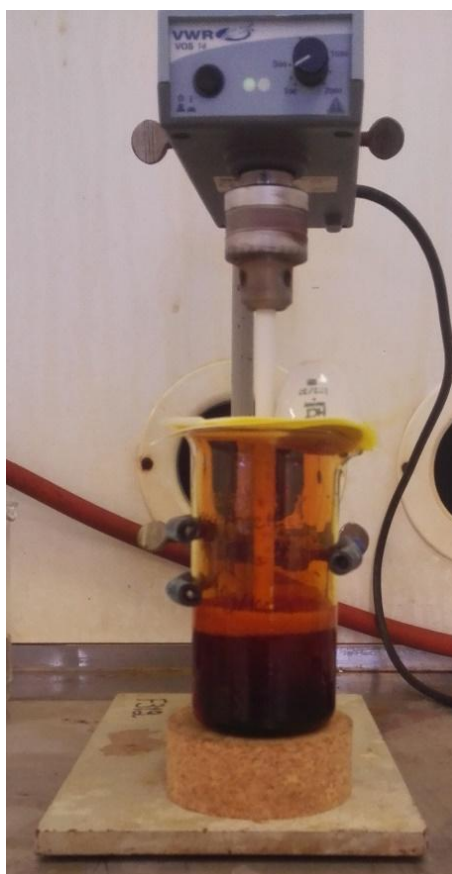
Kuva 23. NdFeB -magneettien 10 M HCl + 6 M HNO 3 (3:2) -liuotus sekoituslaitteessa.
