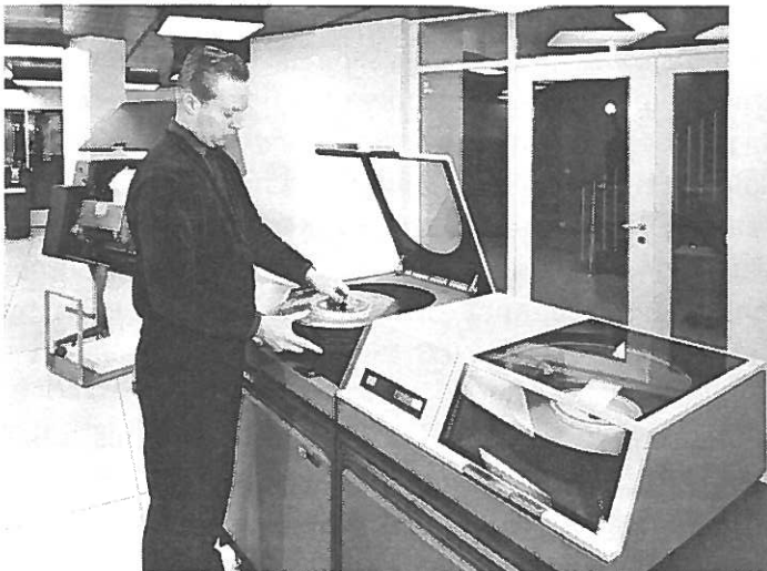
Kuva 26. Ohjelmoija Leo Vornanen vaihtamassa levypakkaa IBM 1311 -levymuistilaitteeseen. Kuva on IBM:n Turun laskukeskuksesta vuodelta 1964. Foto Rautavuori/ Suomen IBM:n arkisto.
