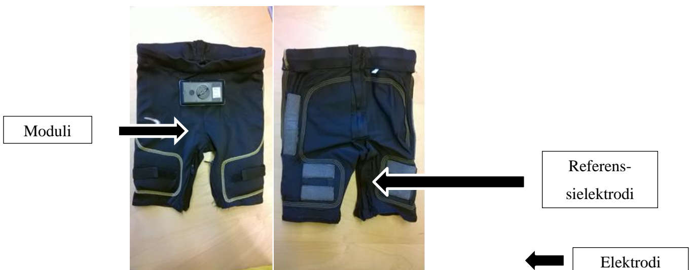
KUVA 10. A) 120 cm:n kokoiset EMG-shortsit sekä moduli (housujen ulkopinta, etupuoli) kuvattuna. B) Housuihin integroidut elektrodit housujen sisäpuolella.
