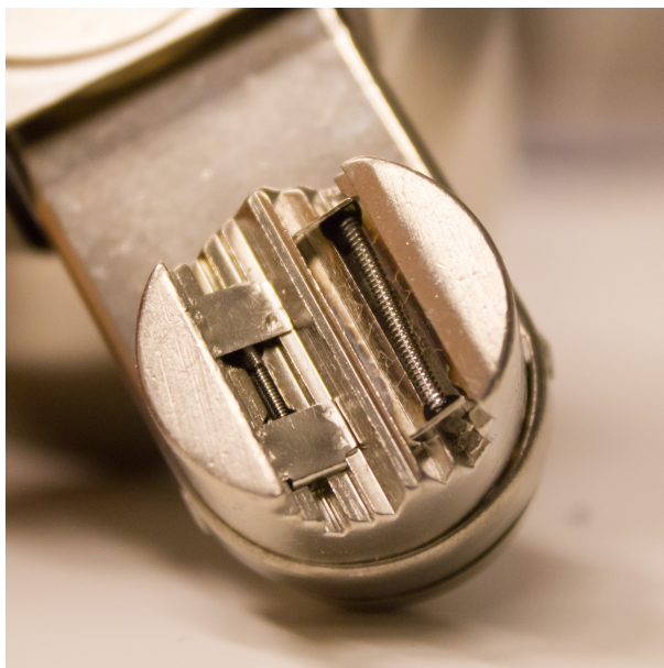
Kuvio 9: Keski-Suomen sairaanhoitopiirin laitetekniikan osastolla esillä ollut, käytöstä poistettu röntgenputken katodi.
