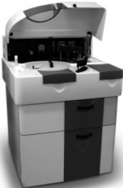
Aquakem 250 edustaa uudenlaista tekniikkaa vesilaboratorioissa. Laitetta käytetään etupäässä vesien kokonaisravinteiden sekä typen ja fosforin yhdisteiden määrittämiseen.
