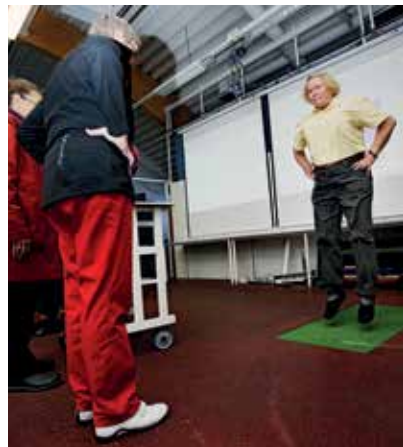
Sirkka Aunola kokeilee Vivecan laboratoriossa voimalevyanturia, joka mittaa hypyssä tuotettua voimaa.
