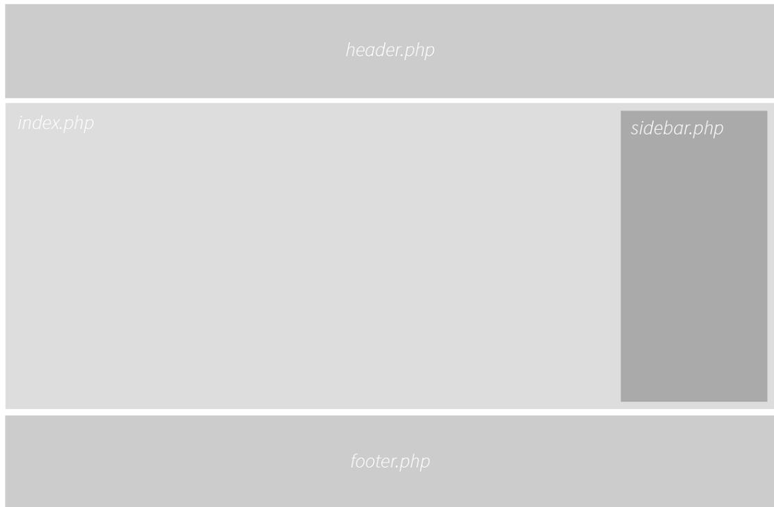
Kuvio 2. Perussivupohjan rakenne. Lähde: (Hedengren (2014))
