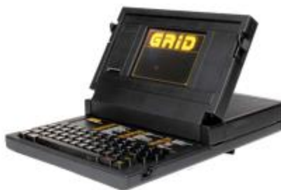
Kuva 2 Vuoden 1982 kannettava tietokone, jossa on EL-näyttö (Oldcomputers)
