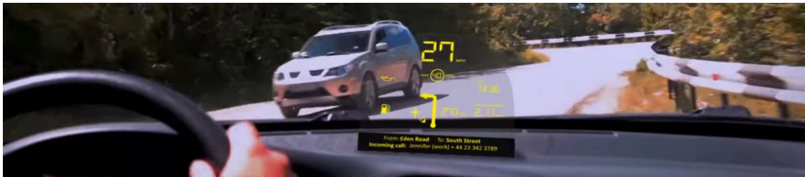
Kuva 8 TASEL ja TFEL-näytöillä varustettu kuvitteellinen HUD-sovellus
