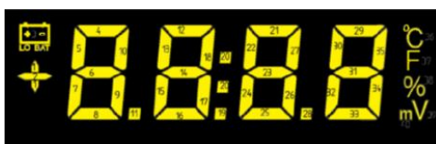
Kuva 6 Esimerkki TFEL-teknologialla toteutettavasta 7-segmenttinäytöstä
