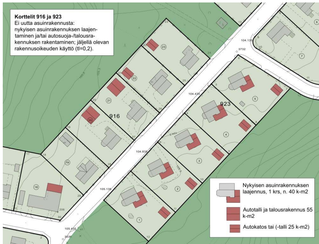
Kuva 30. Olemassa olevan käyttämättömän rakennusoikeuden sijoittaminen tontin takaosaan rakentamalla uusi talousrakennus tai sen käyttäminen nykyisen rakennuksen laajentamiseen.
