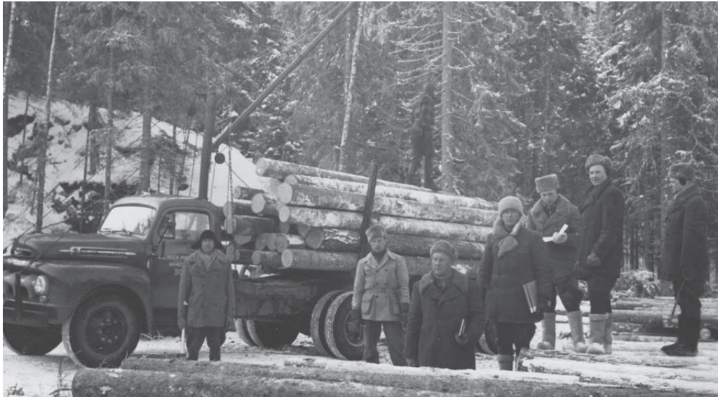
Ennen hydraulisia nostimia tukkikuormat tehtiin vaijerinostureilla ja lihasvoimalla. Kuvassa ollaan metsäosaston laanilla. Oikealla työtä seuraamassa Aimo Kaloinen.
