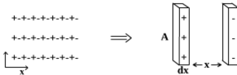
Kuva 1: Vastakkaisista varauksista koostuva varausjakauma, jonka positiivisista ja negatiivisista varauksista koostuvat dx paksuiset levyt, joiden etäisyys toisistaan on x , synnyttävät välilleen sähkökentän E .
