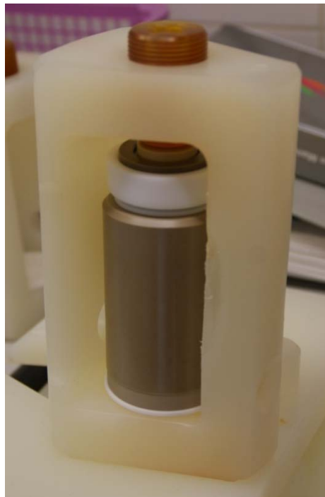
Kuva 9: Mikroaaltouunin näyteastia valmiina siirrettäväksi mikroaaltouuniin
