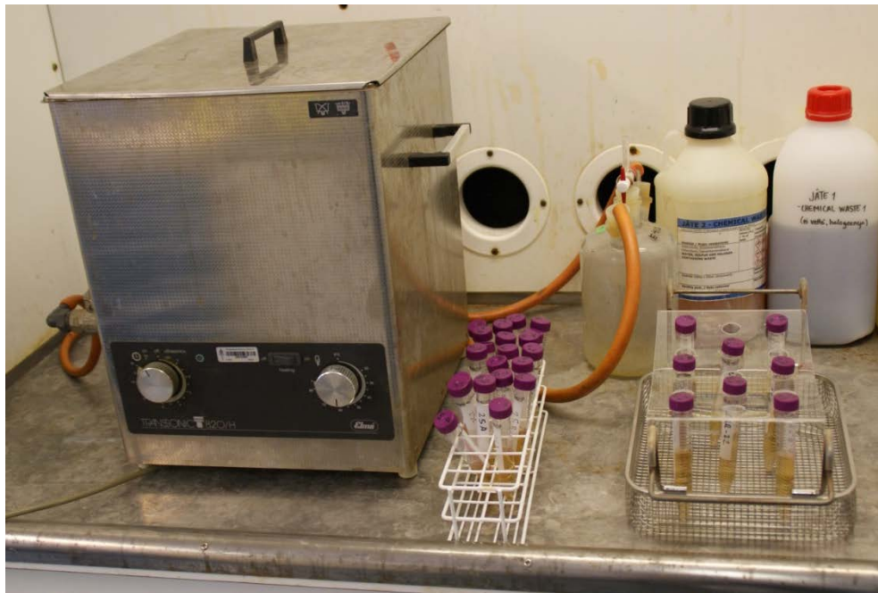
Kuva 10: Ultraäänihaude ja ultraäänikäsittelyä odottavia näytteitä
