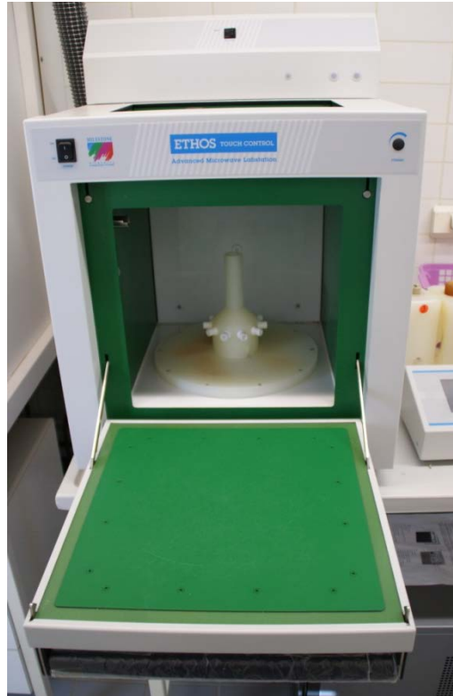
Kuva 8: Näyteliuotukseen käytettävä mikroaaltouuni Milestone Ethos Plus
