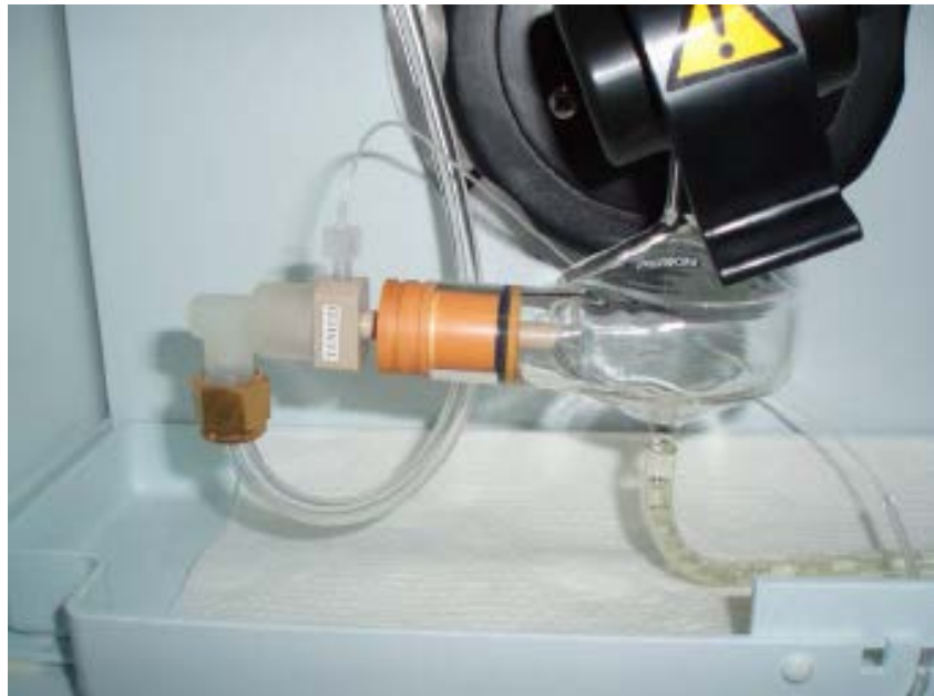
Kuva 15: GemGone sumutin kiinnitettynä sykloniseen sumutinkammioon ja soihdun ohjausrunkoon. 74
