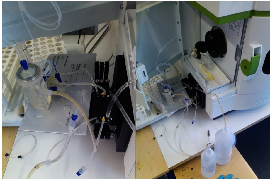
Kuva 17 ja 18: Hydridimenetelmän näytteesyöttö
