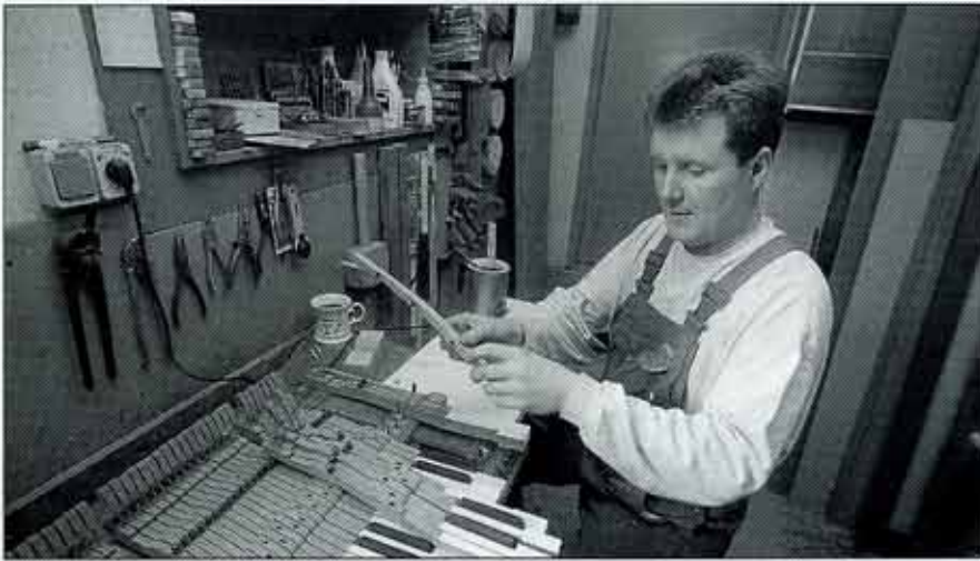
Klavierbauer Thomas Reisberg repariert die Tastatur eines Steinway-Flügels.
