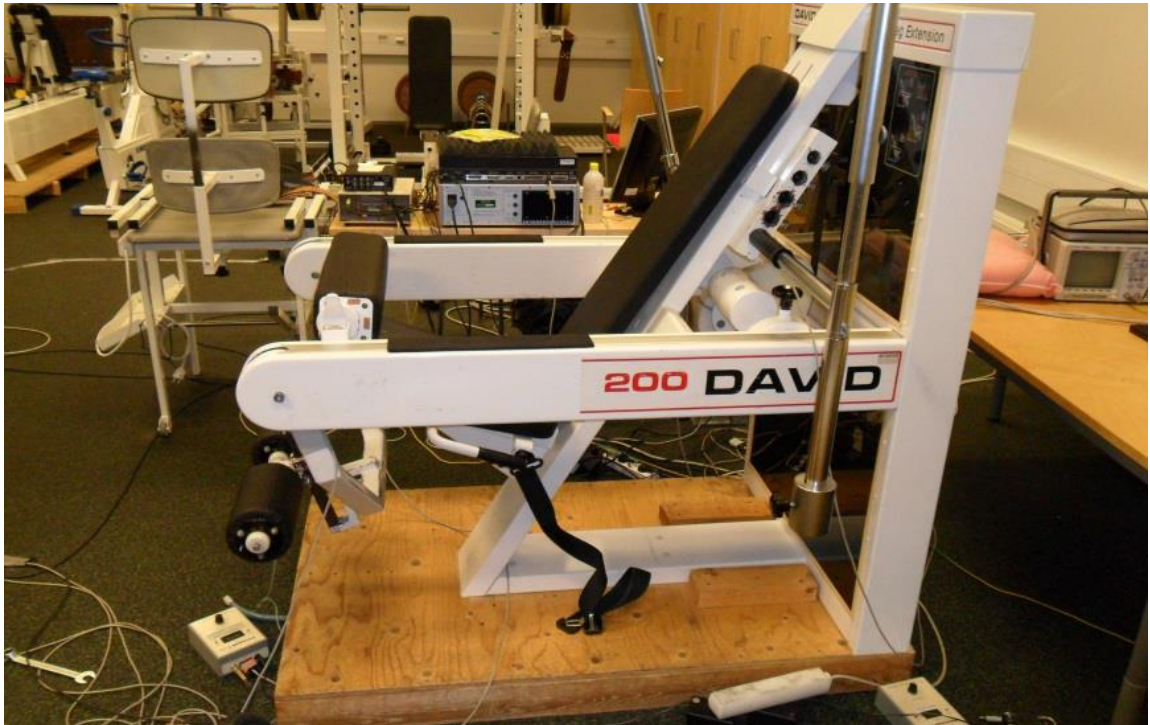
KUVA 5. David 200 polven ojennus ja koukistus -laitetta (David Health Solutions Ltd, Helsinki, Finland) oli muokattu tutkimusta varten isometriseksi Jyväskylän yliopiston toimesta (Liikuntabiologian laitos, Jyväskylän yliopisto, Suomi).
