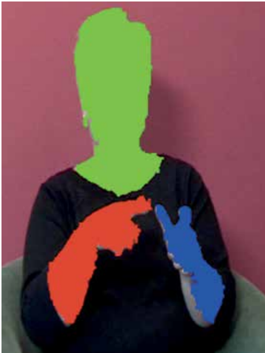
Viittomien analyysiohjelma on tunnistanut kolme ”artikulaattorimöykkyä” ja merkinnyt ne värein. Kunkin kuvattavan liikettä voidaan seurata erikseen. Ohjelmisto on valmistettu Aalto-yliopistossa.
