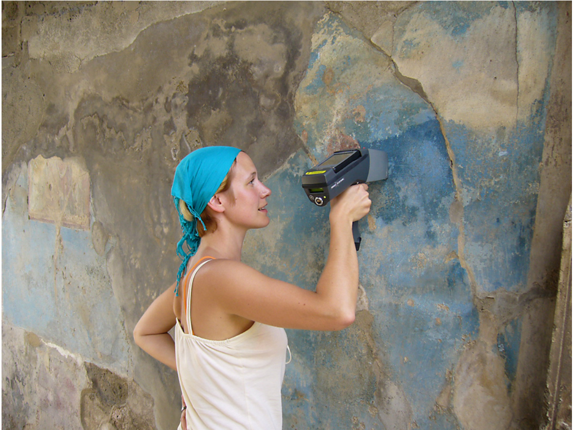
Kuva 4. Non-invasiivinen röntgenfluoresenssilaitte (EDXRF) käytössä Marcus Lucretiuksen talon pigmenttien alkuaineanalyyseissä.
