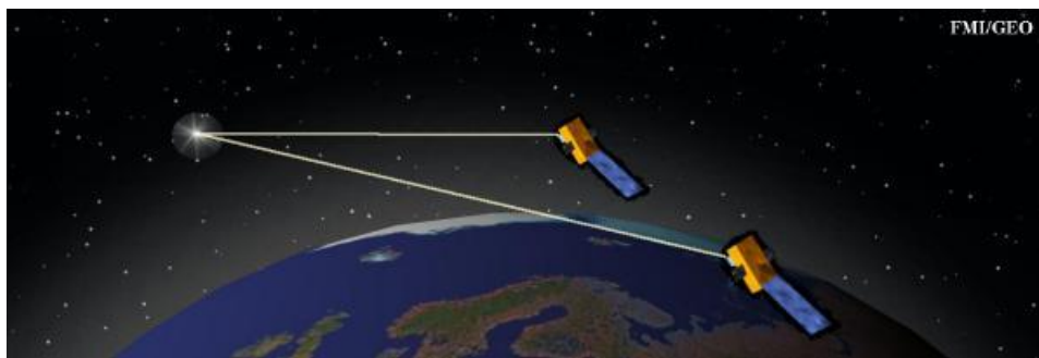
KUVA 3.2. GOMOS-instrumentin toimintaperiaate (Kuvan lähde: Ilmatieteen laitos)
