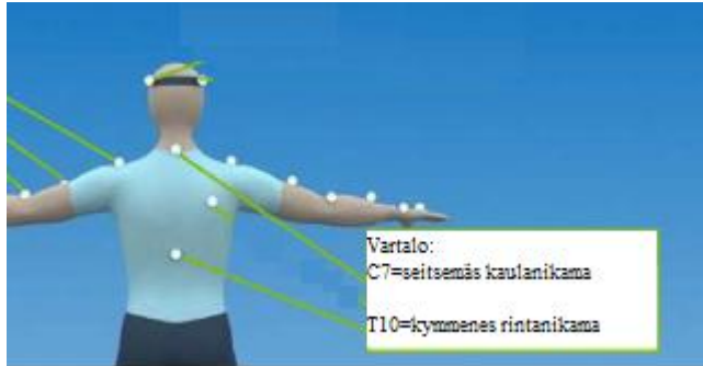
KUVA 10. Ylävartalon markkerit takaa. Taakse kiinnitettiin markkerit vain nikaman C7 ja T10 kohdille. (Vicon Product guide 2).
