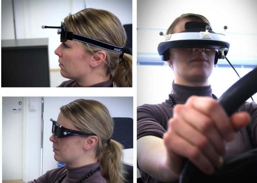
Kuvio 2. Käytetyt laitteistot. Vasemmalla ylhäällä pääpanta, vasemmalla alhaalla 3D-lasit. Oikealla HMD-laite.
