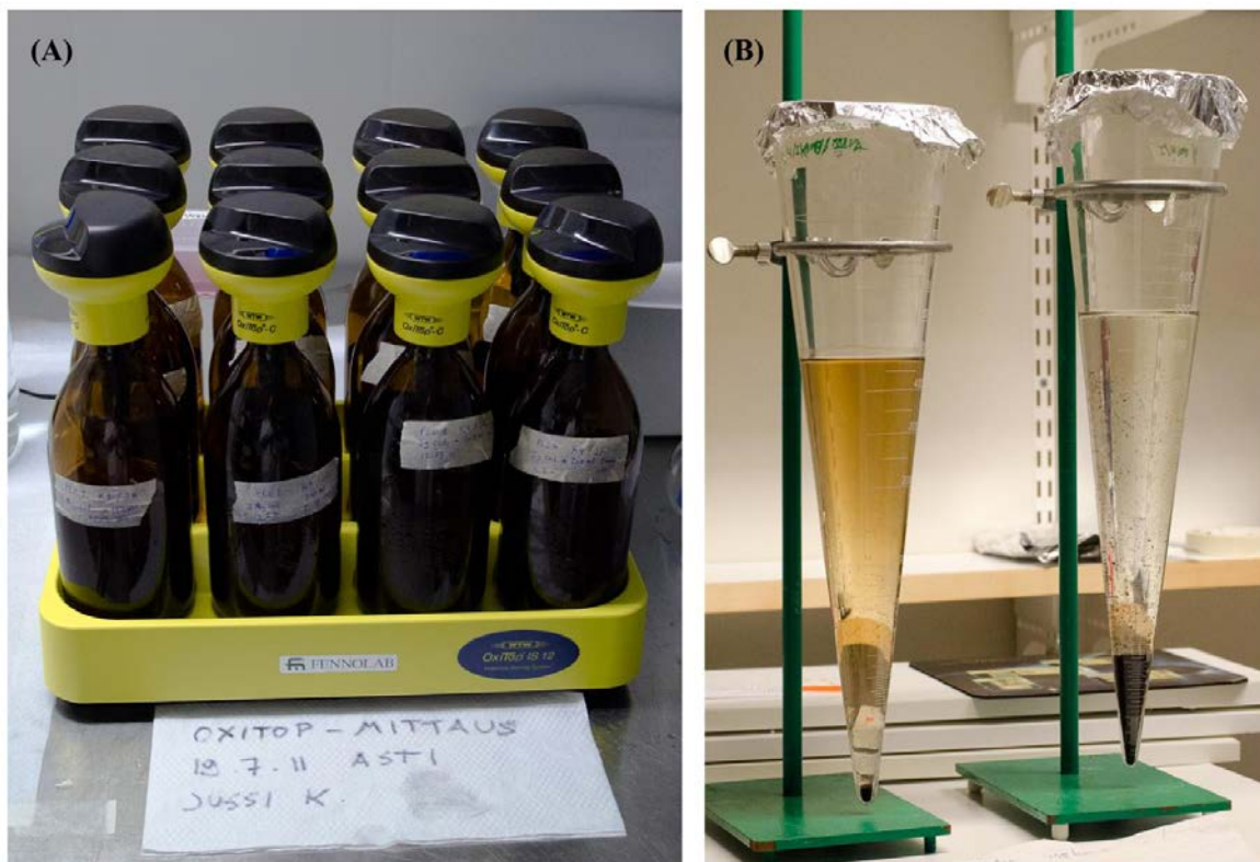
Kuva 15. (A) Kiintoaineen biokemiallista hapenkulutusta mittaava OxiTop-laitteisto. Laitteisto koostuu näytteet sisältävistä lasipulloista, paine-eroja mittaavista mittauspäistä ja magneettisekoitus-alustasta. (B) Imhoff-suppiloita, joilla määritettiin kiintoaineen tilavuus 24 tunnin laskeutuskokeella. Molemmissa suppiloissa on 500 ml näytettä.
