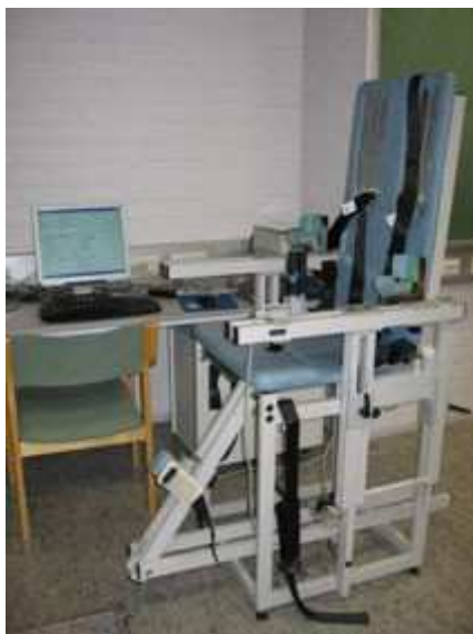
Kuva 4. Maksimaalisen isometrisen polven ojennus- ja koukistusvoiman mittaamiseen käytetty voimatuoli (Voimatuoli 2013).
