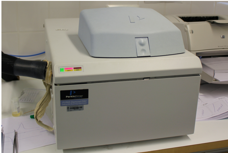
Kuva 7: Jyväskylän Yliopiston kemian laitoksen Perkin Elmer Pyris Diamond DSC -laitteisto
