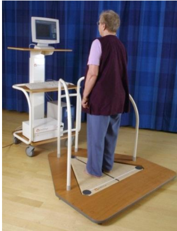
Kuva 11. Tasapainon mittaus Good Balance- laitteistolla (kuva:Metitur Oy).
