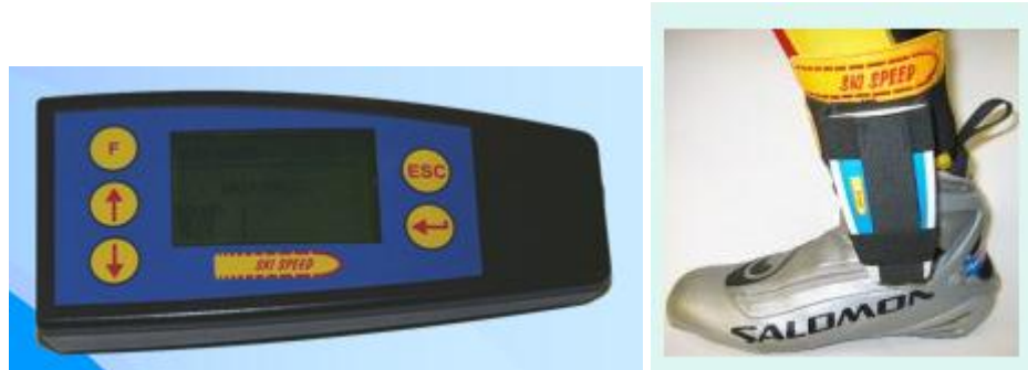
KUVA 13. Skispeed-suksen luiston mittauslaite (Tieto-Oskari Oy)
