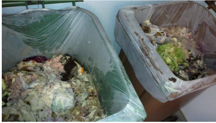
Kuva 12. Kahden biojäteastian päällimmäinen sisältö sekoitettiin niin, että puolet kahdeksan litran näytteenottosangon tilavuudesta otettiin puoliksi molemmista jäteastioista.
