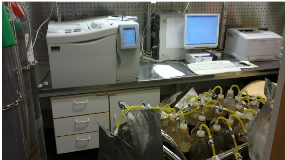
Kuva 14. Panoskoepulloihin (edessä) oli liitetty ilmatiivis näytteenottoelinjasto, joka sisälsi kaasunkeräysputken, lasivialin ja kaasupussin. Kertyneen biokaasun metaanipitoisuus mitattiin kaasukromatografilla (takana).
