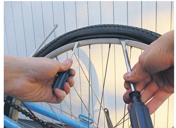
4. Ulkokumin saa muljautettua sijoiltaan meisseleillä.
