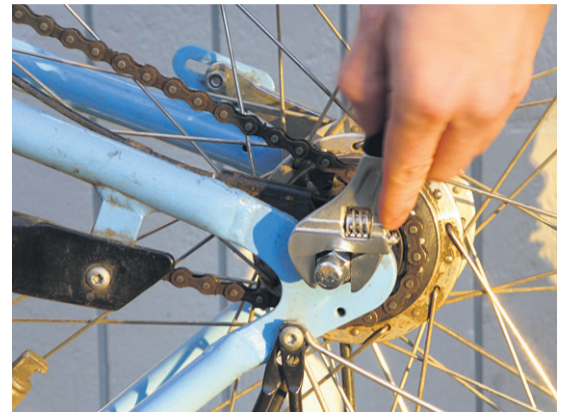
2. Ensin pyörä ylösalaisin ja sitten kiinnitysmutteri irti.
