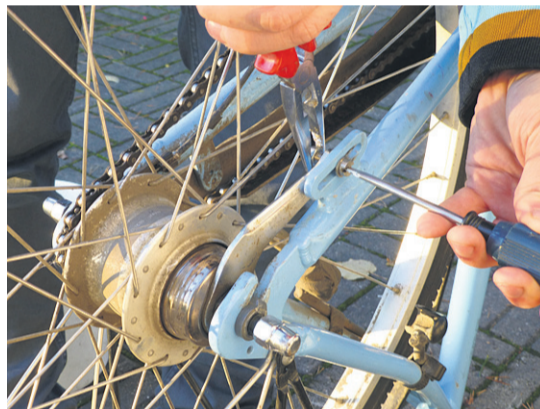
3. Takapyörästä tulee irrottaa myös jarrukäpälän ruuvi.
