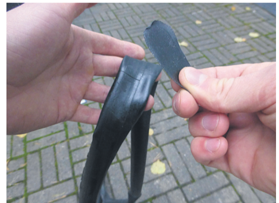
6. Kuivaa vuotokohta ennen paikan liimaamista.
