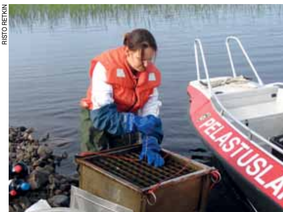
Tutkija Marja Lahti Petäjavedellä tekemässä tutkimusta vesistöihin kertyneiden lääkeaineiden esiintymisestä. Metalliseen keräimeen laskeutuu kiinteätä ainesta, joka kerätään talteen ja analysoidaan.
