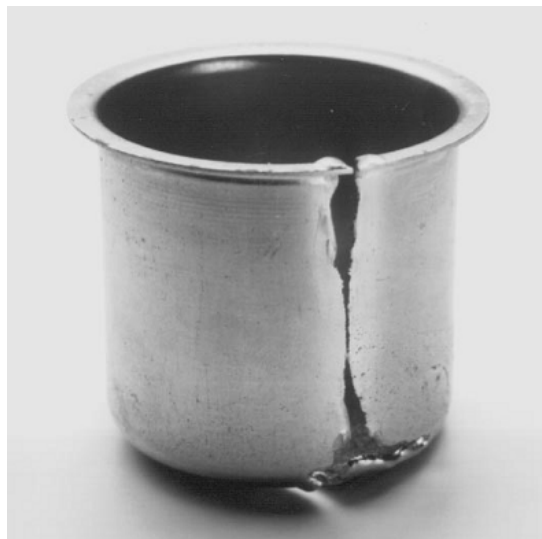
Kuva 6.17 Piikarbidi kontaminaatiosta alkanut eutektisen Pt-Pt 3 Si-seoksen aiheuttama korroosio Pt – 5 % Au-upokkaassa. 111
