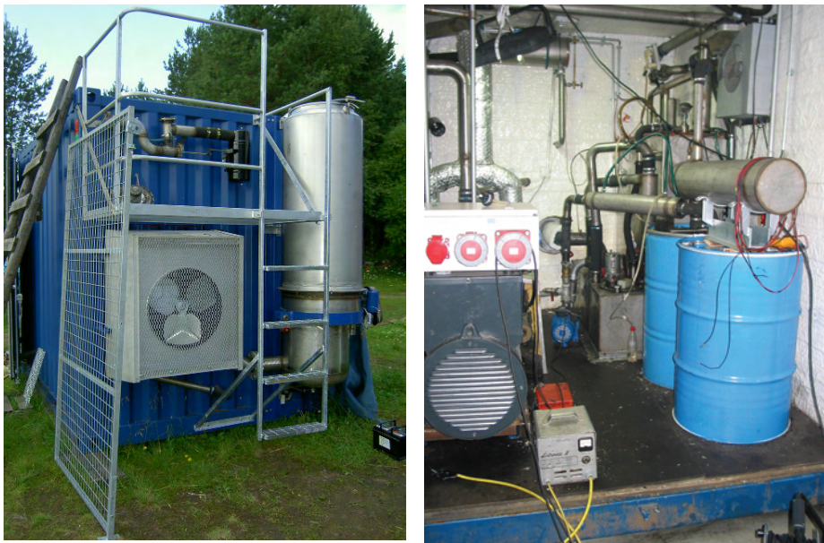
FIGUR 1. CENTRIAs medströmsförgasare baserar sig på patenterad EK-förgasningsteknologi.
