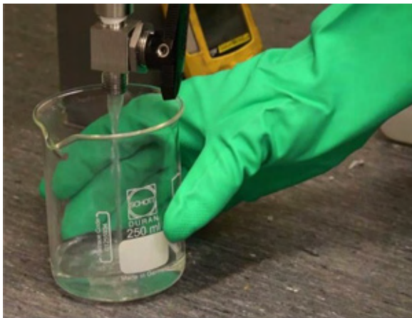
FIGUR 6. Metanol tappas ut från testanläggningen. Metanolen var tillverkad via svartlutsförgasning.
