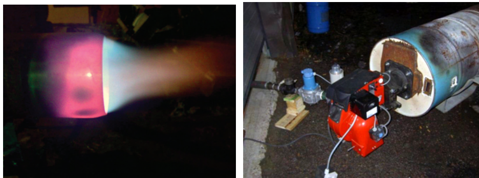
FIGUR 4. Utvärdering av specifik gasproduktion med en gasbrännare. Gasbrännare som matats med trägas (till vänster) och testanordning (till höger).
