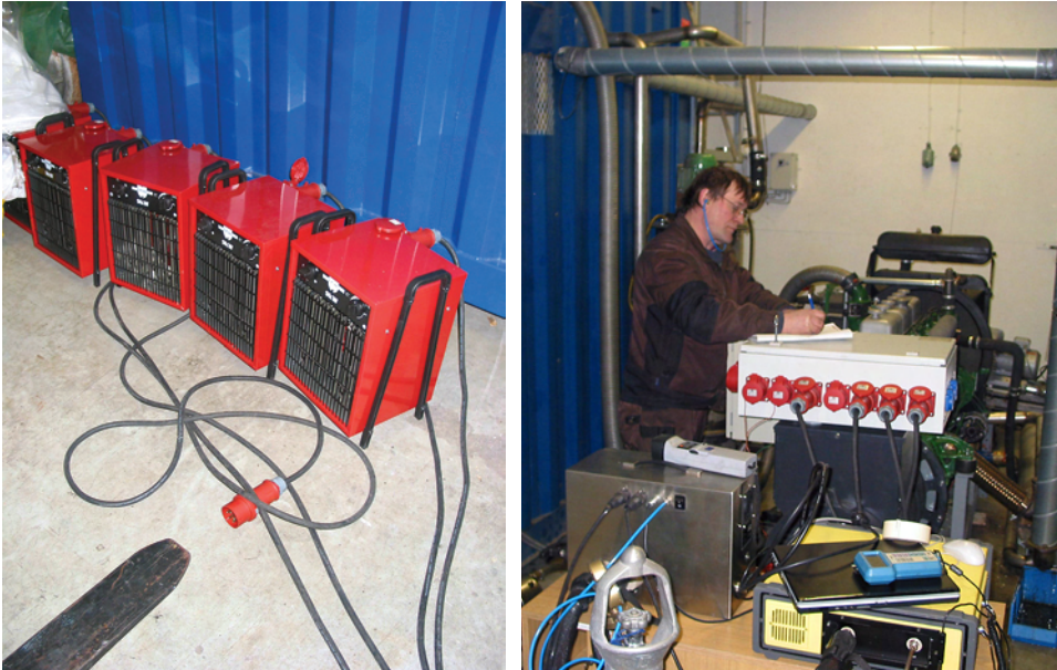
FIGUR 3. Undersökning av gasproduktion och bränslekonsumtion för den modifierade 8 liters, 6-cylindriga förbränningsmotorn. Elektrisk kraftbelastning på 9 kW användes i experimentet (till vänster) och förbränningsgasmotorn (till höger).
