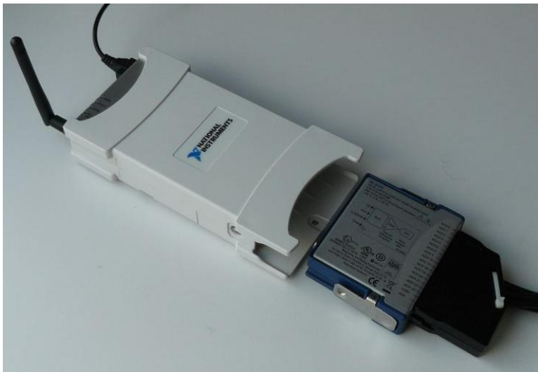
Kuva 10. Tiedonkeruukortti NI 9205 ja langaton lähetin NI 9163.
