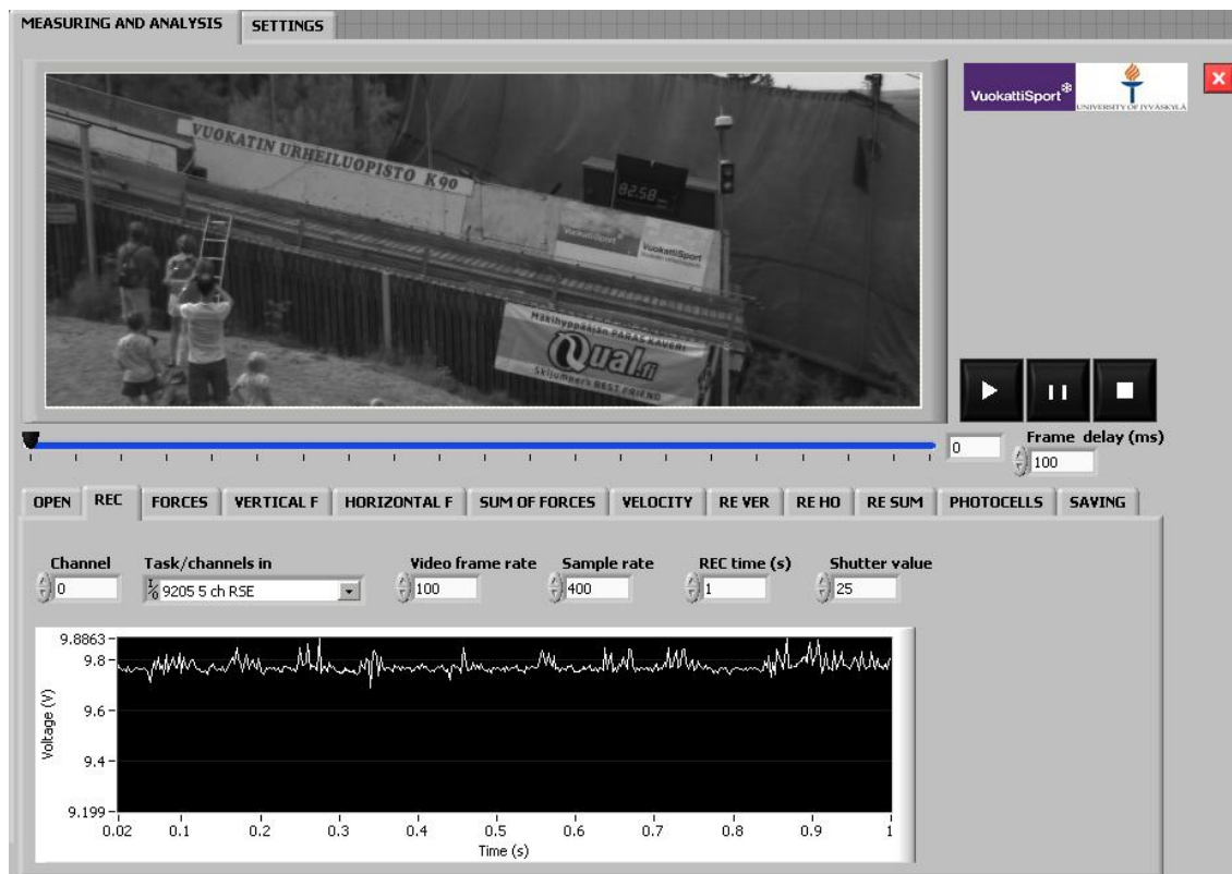
Kuva 14. Mittausvaiheen asetukset. Välilehdellä asetetaan kameras kuvanottotaajuus (Video frame rate), voima- ja valokennodatan näytteenottotaajuus (Sample rate), tallennusaika (REC time) ja kameras sulkijan nopeus (Shutter value).
