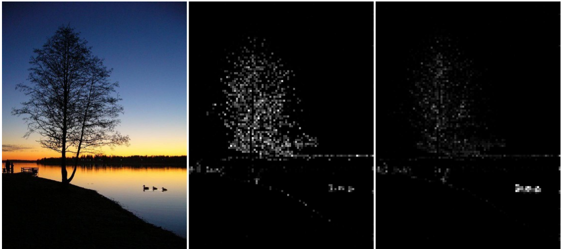
Kuva 23: Maisemaan on lisätty sorsapoikue toisesta valokuvasta. Väärennös on tunnistettu diskreetin kosinimuunnoksen painokertoimien matalia arvoja havaitsemalla. Keskellä kuvan pakkauslaadut ennen ja jälkeen muokkauksen olivat 70 ja 80, oikealla 70 ja 90.
