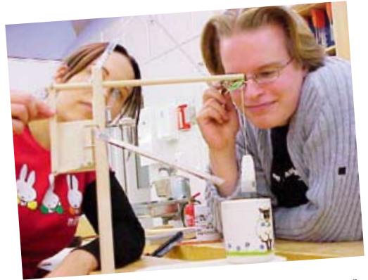
Sonja Virtanen ja Ville Heilala valmiin "teemaschiinan" ääressä. Teepussin lasku ja nosto hoituvat hydraulisesti ja sokeripala pudotetaan vivuston avulla.
