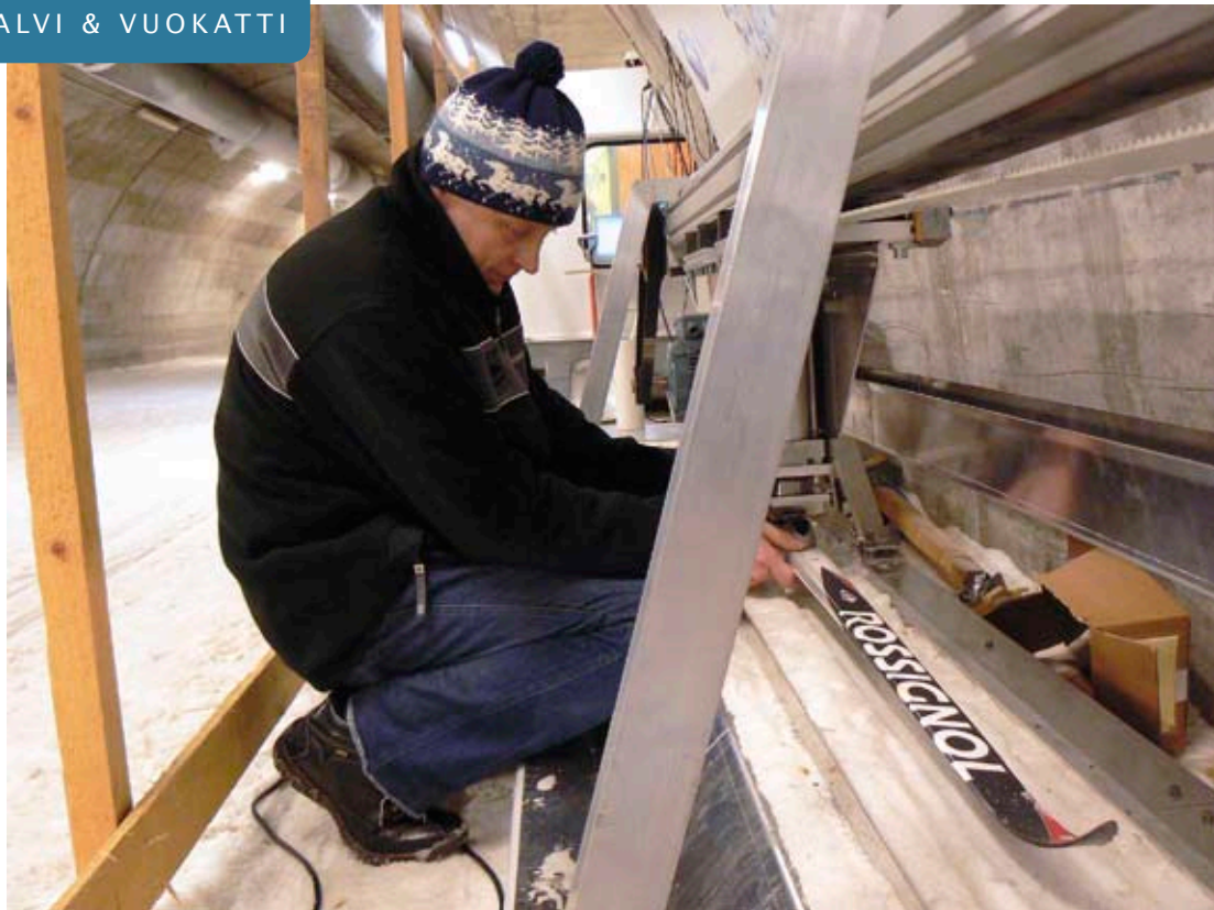
Laboratorioinsinööri Veli Kolehmainen testaa suksenliikutuslaitetta hiihtoputkessa. Mittaukseen tarvittavat tietokoneet sijaitsevat lämpimässä kopissa kuvassa takana.
